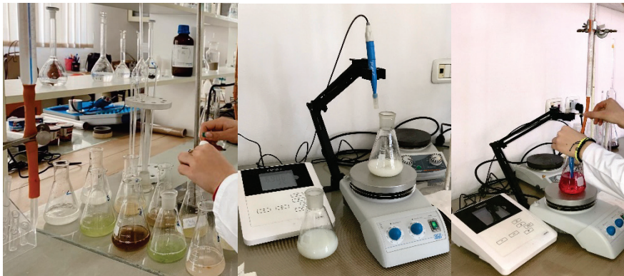
Figure 14: Aciditeti total i përcaktuar me metodën potenciomtrike
