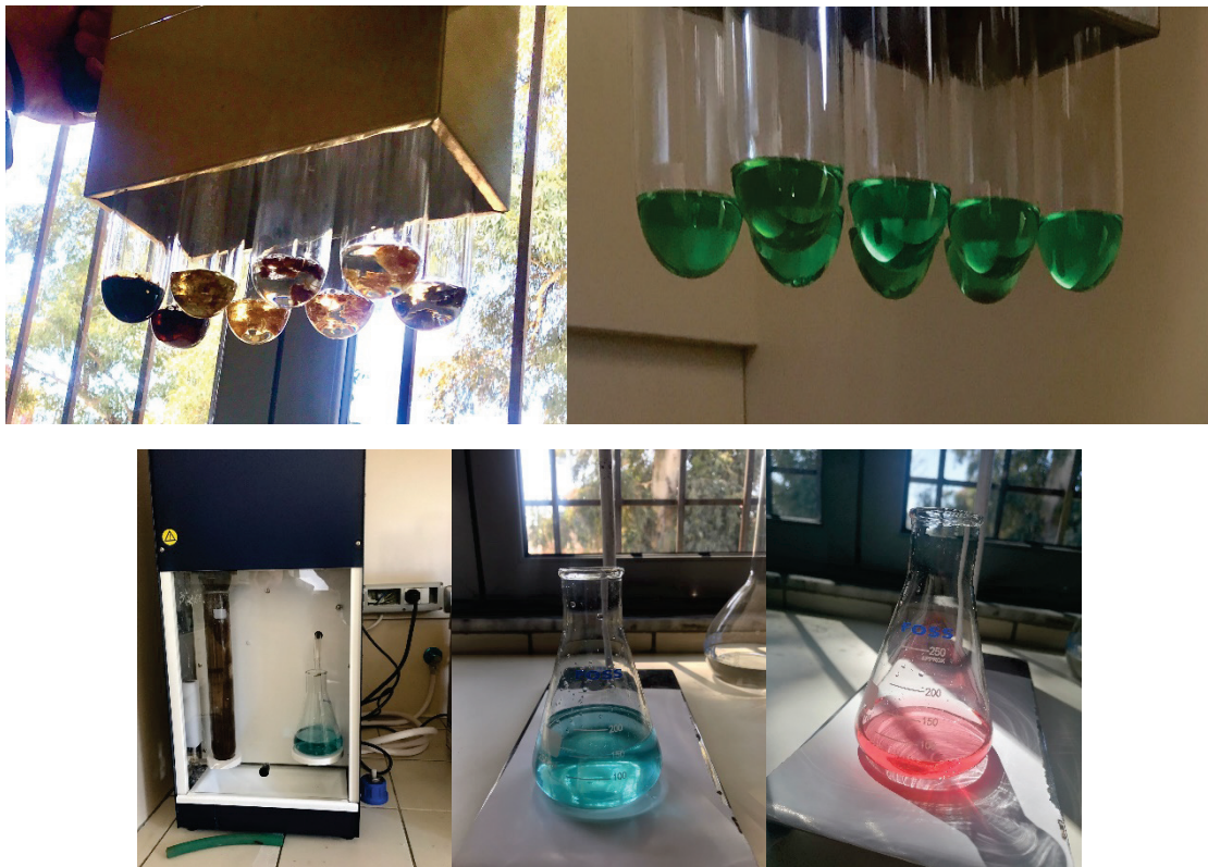
Figura 10: Proteina totale e përcaktuar me metodën Kjeldahl
